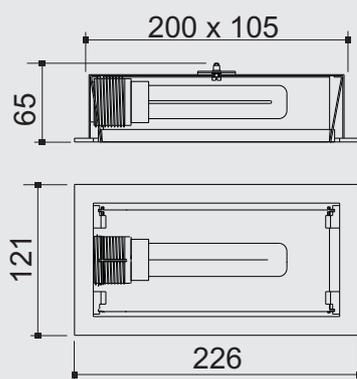
**Especificação:** Embutido retangular em alumínio e pintado por processo eletrostático. Refletor em alumínio anodizado de alto brilho e grelha duplo-parabólica metalizada. Fixação ao forro por meio de suporte metálico.
