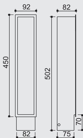
**Especificação:** Balizador de embutir em parede em alumínio pintado por processo eletrostático com refletor liso.
