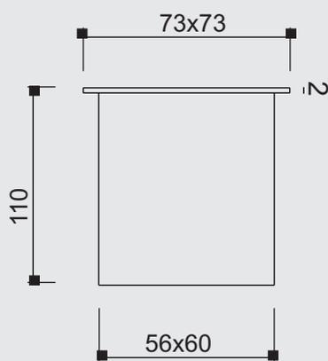
Balizador quadrado em alumínio pintado por processo eletrostático e vidro temperado fosco.
