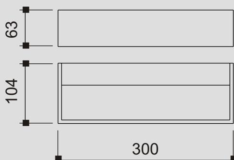
**Especificação:** Arandela retangular em alumínio pintado por processo eletrostático e vidro temperado fosco. Esta peça não tampa ponto de alimentação elétrica.
