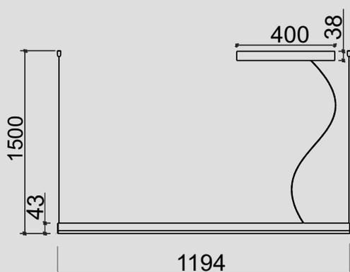
Especificação: Pendente em perfil de alumínio pintado por processo eletrostático, difusor em policarbonato com foco de luz direcionado para baixo.
