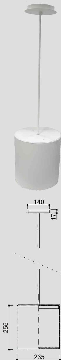
**Especificação:** Pendente cilíndrico em alumínio tratado e pintado por processo eletrostático. Refletor interno em alumínio e compartimento interno para reator.
