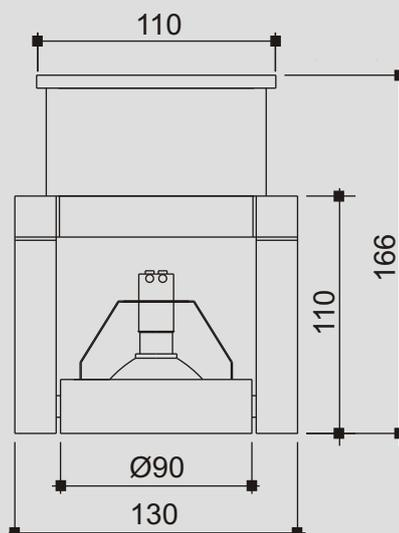
Especificação: Spot em alumínio pintado por processo eletrostático com anéis de orientação do foco. Fixação através de canopla.
