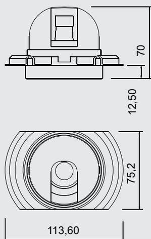
**Especificação:** Embutido redondo com foco recuado orientável, fabricado em alumínio tratado por fosfatização e pintado por processo eletrostático. Fixação ao forro através de parafusos.
