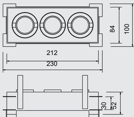
**Especificação:** Caixa mix embutida branca, fabricado em alumínio, e pintado por processo eletrostático. Sistema de orientação do foco da lâmpada.
