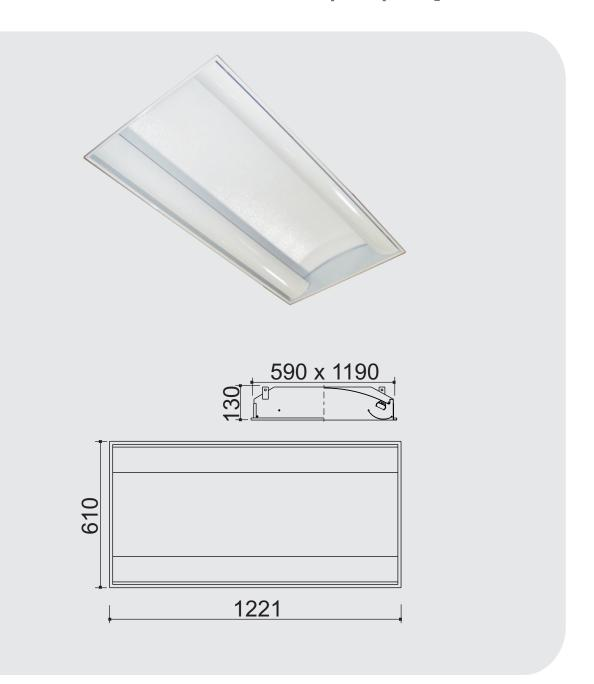
Luminária de embutir em aço tratado e pintado por processo eletrostático. Refletor interno em alumínio pintado e aletas anti-ofuscamento brancas. Fixação através de tirantes.
