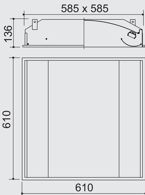
Luminária de embutir em aço tratado e pintado por processo eletrostático. Refletor interno em alumínio pintado e aletas anti-ofuscamento brancas. Fixação através de tirantes.
