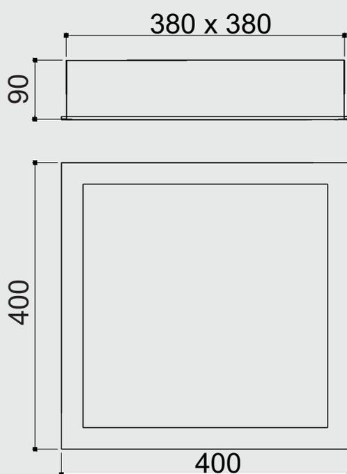
Luminária de embutir em aço tratado e pintado por processo eletrostático. Refletor interno em alumínio de alto brilho. Difusor em policarbonato. Fixação através de tirantes
