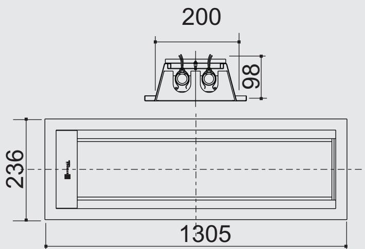
Luminária de embutir em aço tratado e pintado por processo eletrostático. Refletor interno em chapa pintada. Fixação por meio de tirantes.
