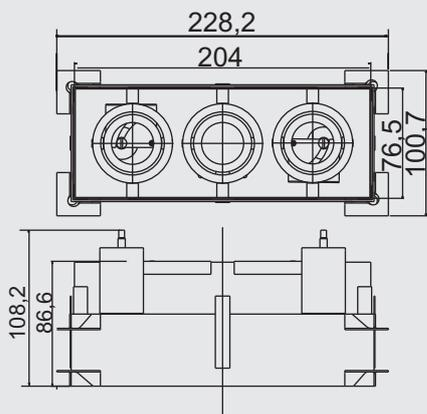
**Especificação:** Caixa mix embutida retangular no frame fabricado em alumínio pintado por processo eletrostático. Sistema de orientação do foco da lâmpada. Fixação chumbada ao forro.
