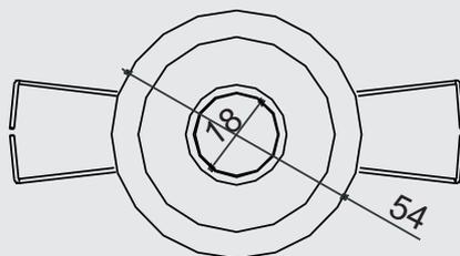
**Especificação:** Embutido redondo com foco fixo, fabricado em alumínio tratado por fosfatização e pintado por processo eletrostático.
