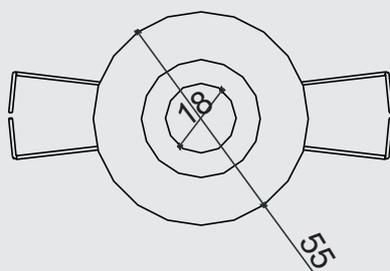
**Especificação:** Embutido redondo com foco fixo, fabricado em alumínio tratado por fosfatização e pintado por processo eletrostático.
