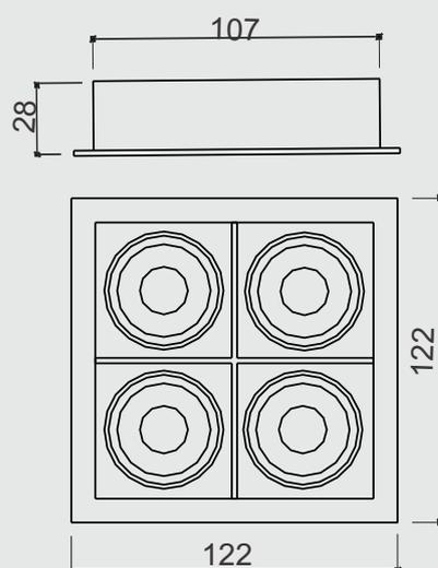
**Especificação:** Embutido quadrado com foco orientável, fabricado em alumínio tratado por fosfatização e pintado por processo eletrostático.
