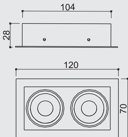
**Especificação:** Embutido retangular com foco orientável, fabricado em alumínio tratado por fosfatização e pintado por processo eletrostático.
