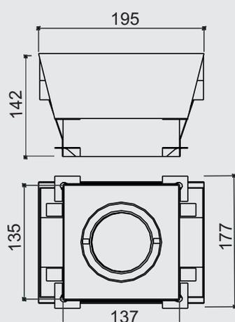
**Especificação:** Embutido quadrado com difusor recuado em policarbonato sem moldura fabricado em alumínio pintado por processo eletrostático. Com sistema de orientação do foco da lâmpada e fixação chumbada ao forro.
