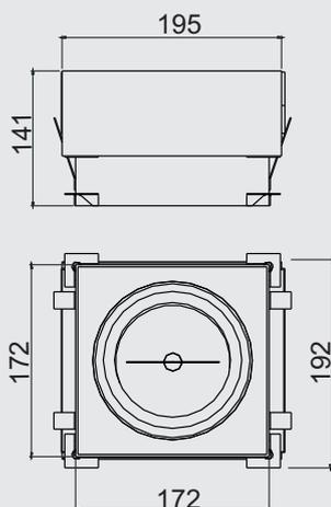
**Especificação:** Embutido quadrado com difusor recuado em policarbonato sem moldura fabricado em alumínio pintado por processo eletrostático. Com sistema de orientação do foco da lâmpada e fixação chumbada ao forro.
