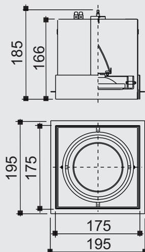
**Especificação:** Caixa mix embutida quadrado no frame fabricado em alumínio pintado por processo eletrostático. Sistema de orientação dos focos da lâmpada. Fixação chumbada ao forro.
