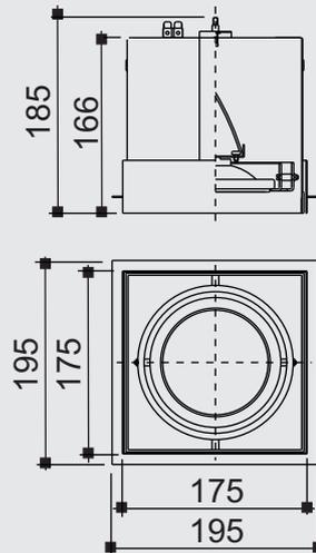
**Especificação:** Caixa mix embutida retangular no frame fabricado em alumínio pintado por processo eletrostático. Sistema de orientação do foco da lâmpada. Fixação chumbada ao forro.
