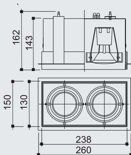
**Especificação:** Caixa mix embutida quadrado no frame fabricado em alumínio pintado por processo eletrostático. Sistema de orientação do foco da lâmpada. Fixação chumbada ao forro.
