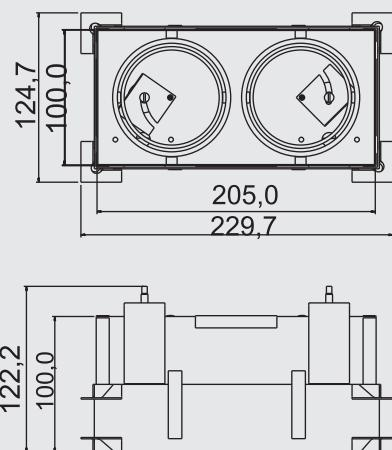
**Especificação:** Caixa mix embutida retangular no frame fabricado em alumínio pintado por processo eletrostático. Sistema de orientação dos focos das lâmpadas. Fixação chumbada ao forro.
