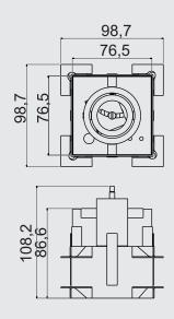
**Especificação:** Caixa mix embutida quadrado no frame fabricado em alumínio pintado por processo eletrostático. Sistema de orientação do foco da lâmpada. Fixação chumbada ao forro.
