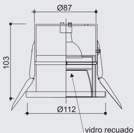
**Especificação:** Embutido cilíndrico em aço tratado por processo de fosfatização e pintado por processo eletrostático. Refletor interno metalizado em vidro temperado transparente. Fixação ao forro por meio de suporte metálico.
