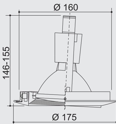
**Especificação:** Embutido cilíndrico orientável em alumínio injetado pintado por processo eletrostático. Anel interno com sistema anti-ofuscamento. Fixação ao forro por meio de suporte metálico.
