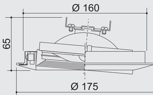
**Especificação:** Embutido cilíndrico orientável em alumínio injetado pintado por processo eletrostático. Anel interno com sistema anti-ofuscamento. Fixação ao forro por meio de suporte metálico.
