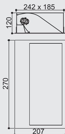
**Especificação:** Embutido retangular para wall washer fabricado em aço tratado por processo de fosfatização e alumínio pintado por processo eletrostático. Refletor assimétrico em alumínio anodizado de alto brilho. Fixação ao forro por meio de suporte metálico
