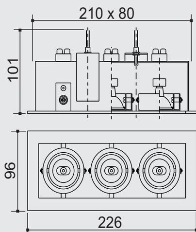
**Especificação:** Caixa mix embutida retangular em aço tratado por fosfatização e alumínio pintado por processo eletrostático. Sistema de orientação dos focos das lâmpadas. Fixação ao forro por meio de suporte metálico.
