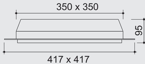
**Especificação:** Semi-embutido em alumínio tratado e pintado por processo eletrostático e difusor em poliestireno e policarbonato.
