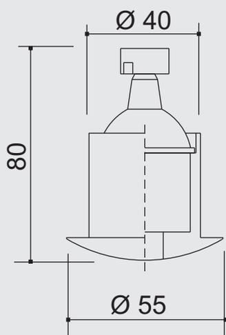
**Especificação:** Embutido cilíndrico em aço tratado por processo de fosfatização e pintado por processo eletrostático. Refletor interno metalizado em vidro temperado transparente. Fixação ao forro por meio de suporte metálico.
