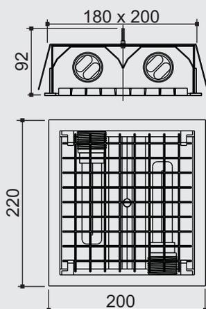
**Especificação:** Embutido retangular em alumínio e pintado por processo eletrostático. Refletor em alumínio anodizado de alto brilho e grelha duplo-parabólica metalizada. Fixação ao forro por meio de suporte metálico.
