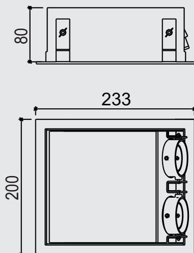
**Especificação:** Embutido retangular em alumínio pintado por processo eletrostático. Sistema de orientação dos focos das lâmpadas.
