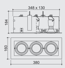
Especificação: Caixa mix embutida retangular em aço tratado por fosfatização
