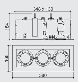
**Especificação:** Caixa mix embutida retangular em aço tratado por fosfatização e alumínio pintado por processo eletrostático. Sistema de orientação dos focos das lâmpadas. Fixação ao forro por meio de suporte metálico.
