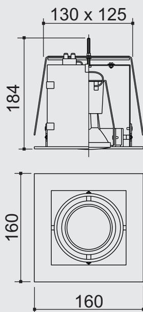
**Especificação:** Caixa mix embutida retangular em aço tratado por fosfatização e alumínio pintado por processo eletrostático. Sistema de orientação dos focos das lâmpadas. Fixação ao forro por meio de suporte metálico.
