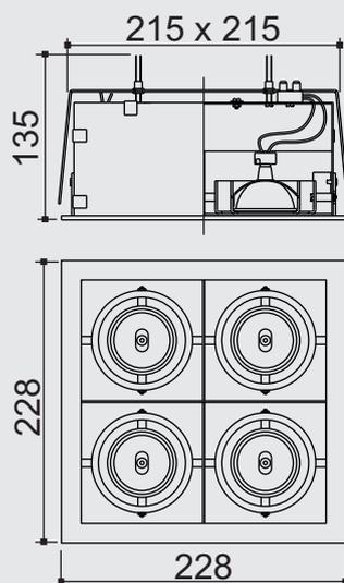
**Especificação:** Caixa mix embutida retangular em aço tratado por fosfatização e alumínio pintado por processo eletrostático. Sistema de orientação dos focos das lâmpadas. Fixação ao forro por meio de suporte metálico.
