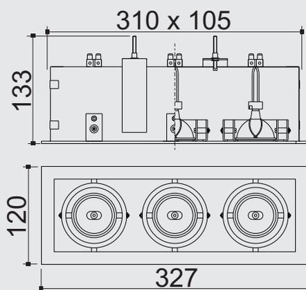
**Especificação:** Caixa mix embutida retangular em aço tratado por fosfatização e alumínio pintado por processo eletrostático. Sistema de orientação dos focos das lâmpadas. Fixação ao forro por meio de suporte metálico.
