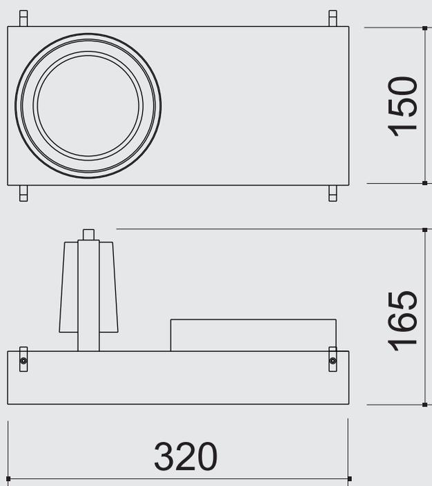
Módulo em perfil de alumínio tratado e pintado por processo eletrostático com sistema de orientação da lâmpada.
