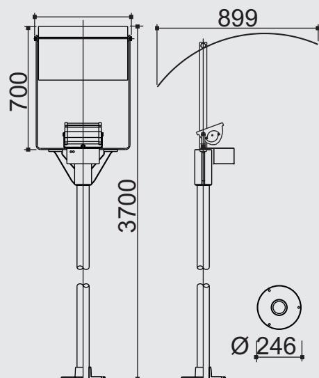
Poste, base, rebatedor e projetor em alumínio pintados por processo eletrostático. Projetor com refletor em alumínio de alto rendimento, vidro temperado transparente, caixa em alumínio para os equipamentos auxiliares, parafusos em aço inox, borracha de vedação. Instalação em base de concreto por meio de chumbadores.
