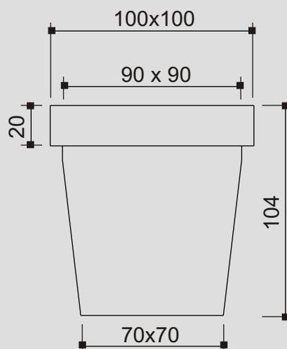
**Especificação:** Balizador quadrado de embutir em parede em alumínio pintado por processo eletrostático. Vidro temperado fosco, quadrado em alumínio pintado por processo eletrostático e vidro temperado fosco.
