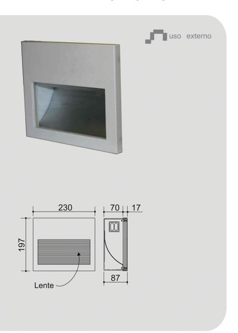
Especificação: Balizador retangular de embutir em parede em alumínio pintado por processo eletrostático. Refletor interno assimétrico em alumínio de alto rendimento, vidro temperado transparente e compartimento interno para equipamento.
