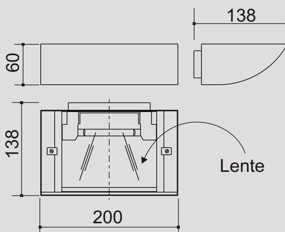
**Especificação:** Arandela tipo pá em aço tratado e pintado por processo eletrostático. Foco de luz assimétrico para cima. Refletor interno em alumínio de alto rendimento e vidro temperado transparente.
