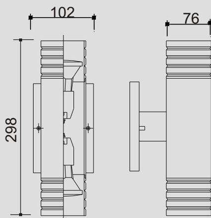
**Especificação:** Arandela cilíndrica em alumínio pintado por processo eletrostático. Foco de luz superior e inferior. Borracha de vedação.
