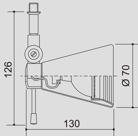
Especificação: Spot cônico em alumínio pintado por processo eletrostático.
